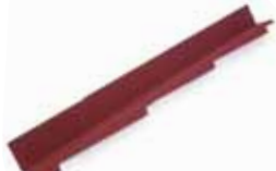
LEM KE ZDI SWT L/R Pravý/Levý Celková délka: 1 385 mm Užitná délka: 1 230 mm Pokrývá 3 řady šablony ST7
