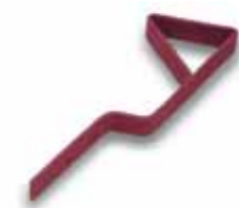
SNĚHOVÝ ROZRAŽEČ SB Materiál: ocelový plech Použití: zabráňuje sjíždění sněhu ze střechy, klade se u okapu a v ploše dle sněhové oblasti
