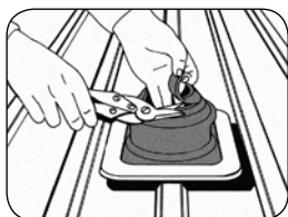
1. Přizpůsobení manžety průměru trubky.
