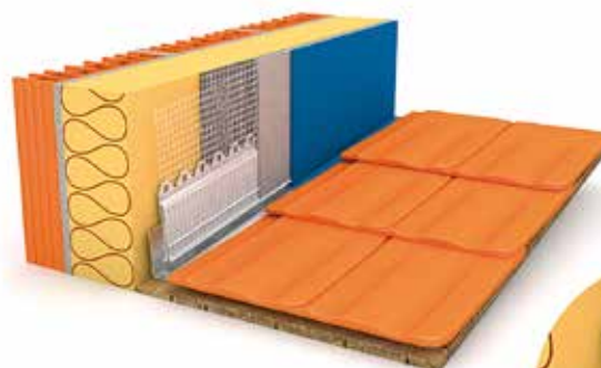
Detail okapnice s tkaninou pro soklový profil
